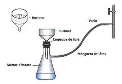
3. Agregar una pequeña cantidad de agua sobre el papel filtro y abrir el vacío. Filtrar el contenido de cada tubo de ensaye, a partir del tubo 1, sobre el papel filtro correspondiente. Evitar pérdidas de precipitado, recuperando el precipitado que se queda adherido al tubo para lo cual es necesario adicionar varias veces agua destilada y verter sobre el papel filtro.
